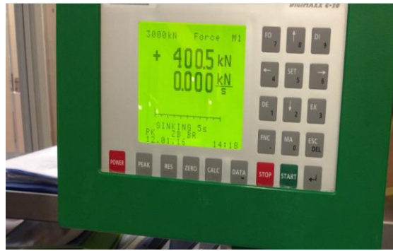
Unversal 10×20, qırılma yükü 400.5 kN, sıxılmada möhkəmlilik həddi 20.0 N/mm 2 (MPa)
